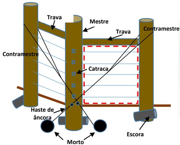
Figura 3: Esquema da construção de canto duplo em ângulo
